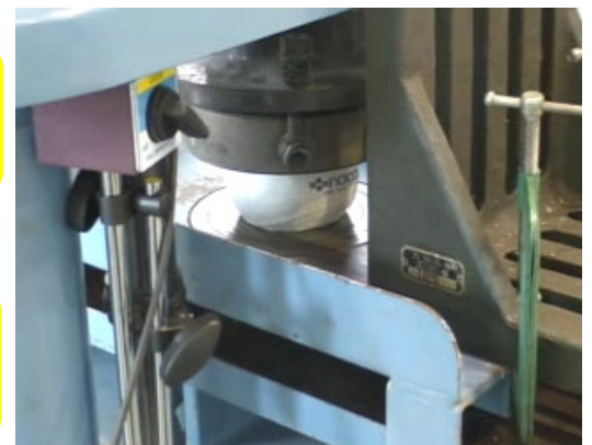
写真-1 ソフトボールの圧縮試験
