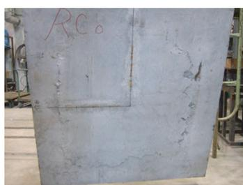
図 押抜きせん断破壊試験 図 押抜きせん断破壊状況
