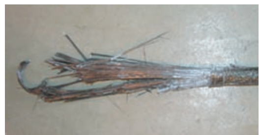
図 アンカー破断状況
