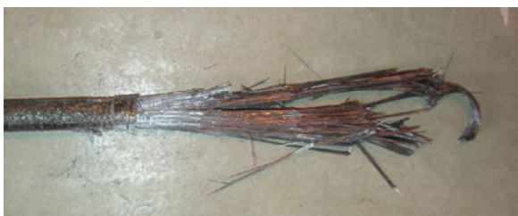
図-8 U 型アンカー破断状況
