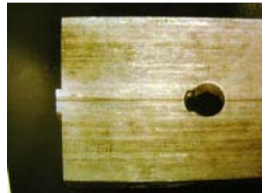
写真-4 破壊状況 (B-Bo)
