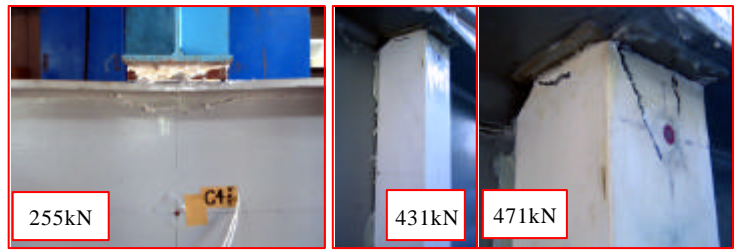
Case A 載荷点位置の破壊 Case B 付着切れ Case B 垂直補剛材の圧壊 写真-2 破壊時の状況
