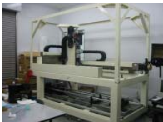
写真 自動配筋ロボット
